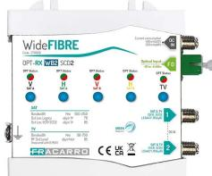
Ricevitore Wide Fibre che converte il segnale ottico proveniente dal trasmettitore OPT-TX WB2 in segnale coassiale; dispone di 2 uscite SCD2 multistandard (SCR/dCSS/dSCR-BSkyB e legacy) con il segnale TV miscelato.
